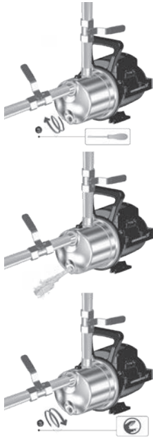
Рис. 13 Опорожнение насоса JP
