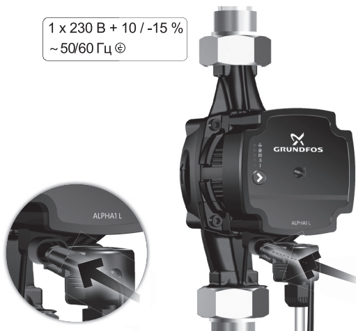
Рис. 9 Подключение сигнального кабеля к ALPHA1 L
